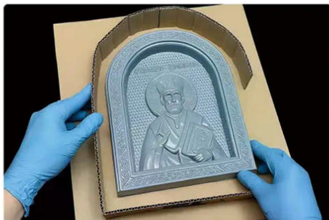
2. Build the Mold Box 2. Создание опалубки
