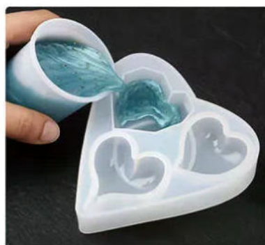
Epoxy Resin Casting エポキシ樹脂の注型
