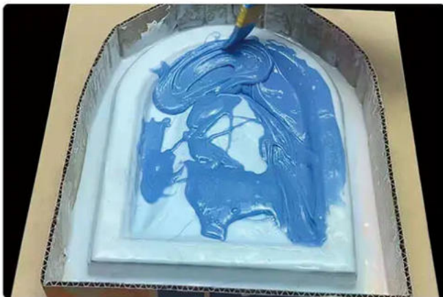
5. Pour or Brush on the Silicone 5. Couler ou appliquer le silicone au pinceau
