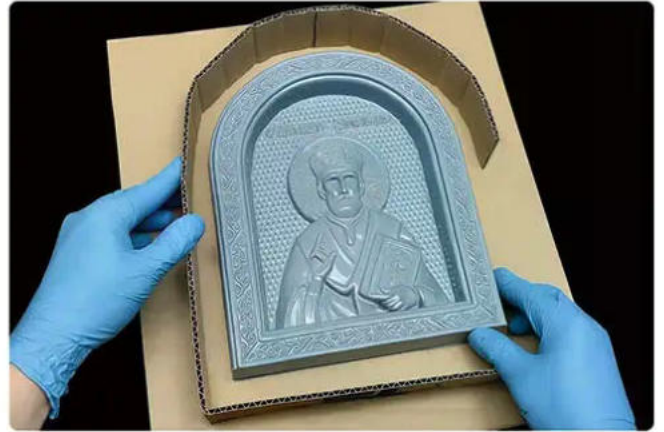
2. Build the Mold Box 2. Construire le coffrage du moule
