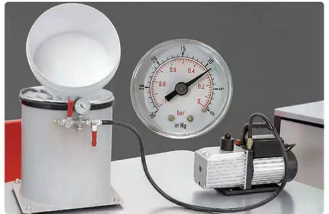
4. Vacuum Degas the Silicone 4. Dégazer le silicone sous vide
