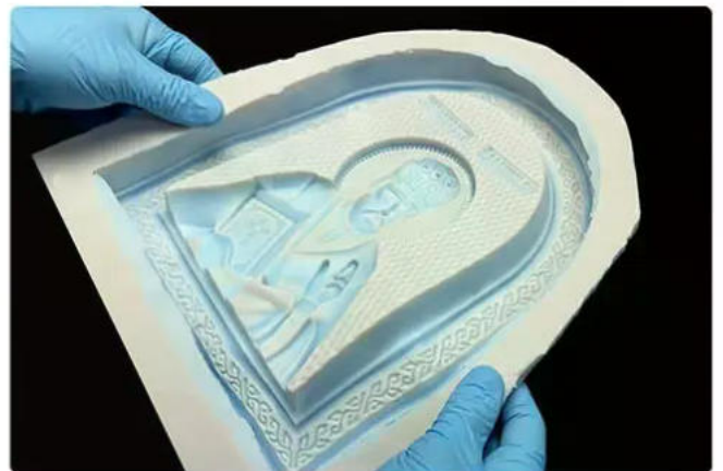
6. Cure and Demold 6. Polymériser et démouler
