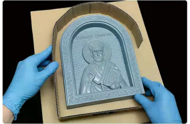
2. Build the Mold Box 2. Construir la caja del molde
