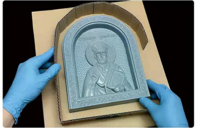
2. Build the Mold Box 2. Den Formkasten bauen
