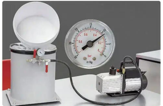
4. Vacuum Degas the Silicone 4. Das Silikon unter Vakuum entgasen
